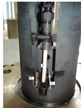
Figura 1. Montagem para realização de ensaios eletroquímicos a alta temperatura.
