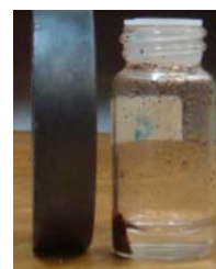
Quitosana magnética separada do líquido em 2 min de aplicação de um campo magnético (ímã).
