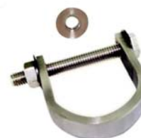
Figura 1. Corpo-de-prova (U-bend) utilizado para os ensaios no meio PWR.
