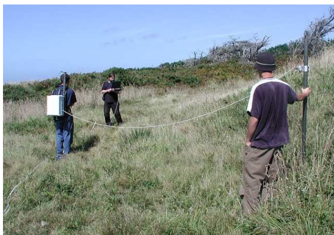
Obrázek 7.1: Ukázka měření v terénu za pomoci terénního zápisníku (směrem od kamery: magnetometr, GPS+elektronika magnetometru, zápisník)
