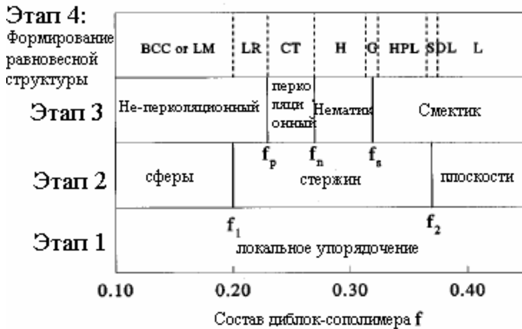
Рис. 1.7. Процесс моделирования микрофазных структур методом DPD. \chi^{eff}N = 20 . Латинскими буквами обозначены мезофазы: BCC – объемно-центрированная кубическая фаза, H – гексагональная фаза, HPL – гексагонально – перфорированная ламеллярная фаза, L – ламеллярная фаза, M, LR, CT – мицеллярная, стержнеобразная жидкая фаза и фаза соединенных трубок, соответственно, SDL – ламеллярная фаза со стабильными винтовыми дислокациями.
