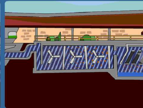
Ανάμιξη για σχηματισμό μεγαλύτερων κόκκων (flocculation)
