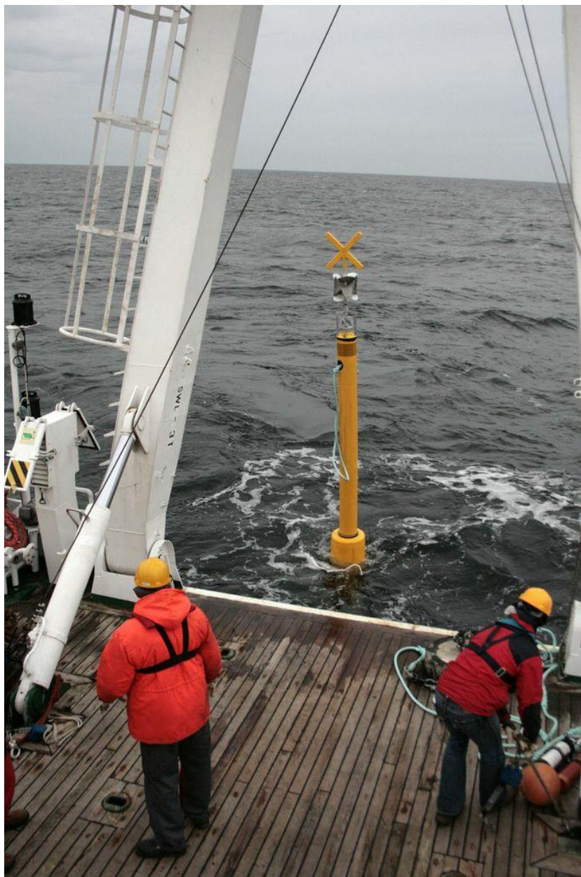
Rys. 10 Zanurzenie systemu kotwiczącego
