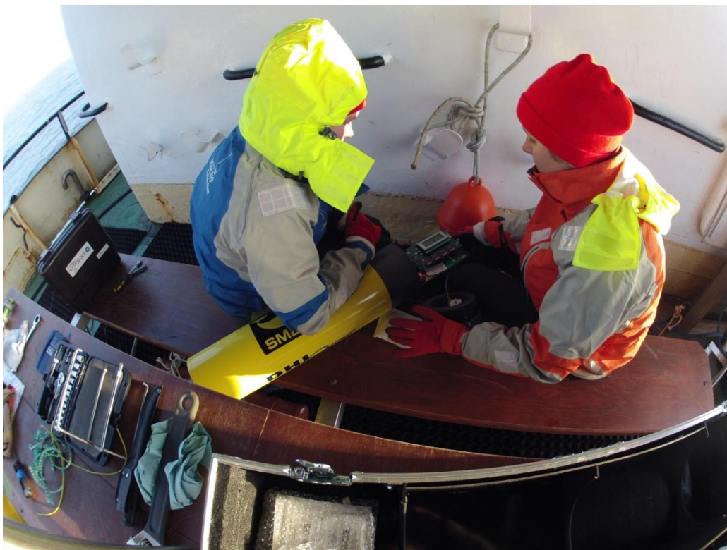
Rys. 11 Ustawianie parametrów rejestrowania danych akustycznych przez urządzenie SM2M przed jego umieszczeniem w wodzie
