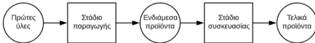
Σχήμα 1.2: Διάγραμμα ροής της παραγωγικής διαδικασίας των απορριπτικών
