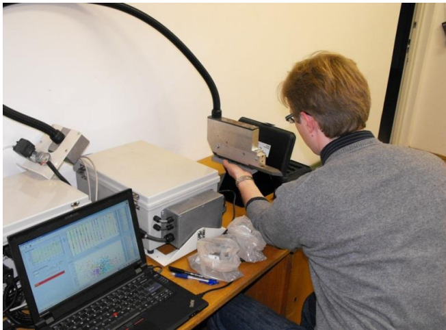
Spektrofotometr VIS-NIR, pomiary laboratoryjne
