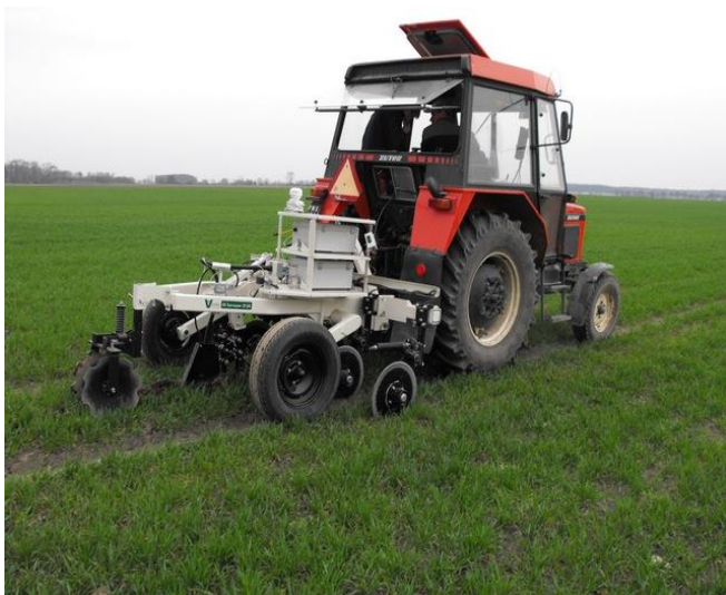
Spektrofotometr VIS-NIR, pomiary „on the go”
