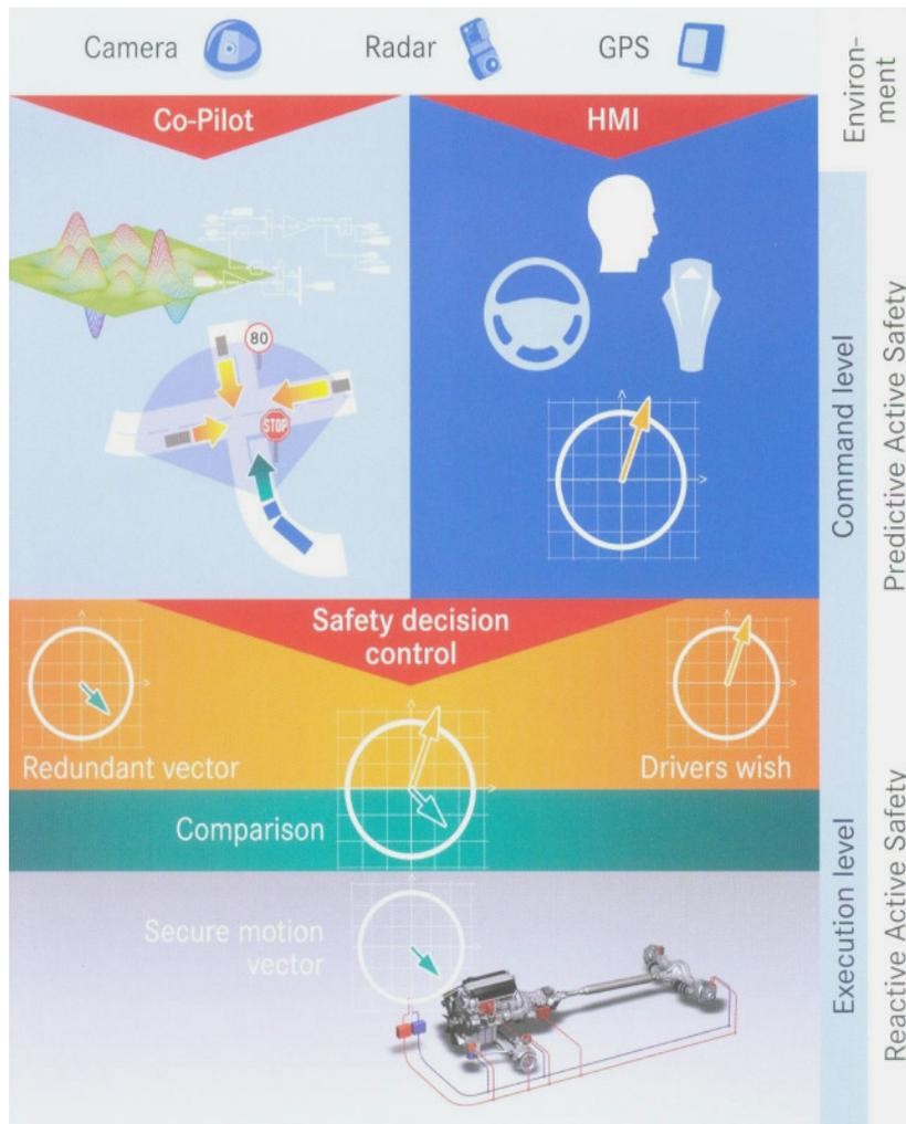
Abbildung 5 Die in SPARC vorgestellte, integrale Struktur und die Aufteilung der Systeme im Fahrzeug sind durch klar definierte Schnittstellen und Strukturen gekennzeichnet. Die so begrenzte Ebenenarchitektur, in die der rein mechanische Antriebstrang mit eingebunden ist (unten), verringert im Vergleich zu heutigen Integrationsabläufen in starkem Maße die Komplexität des Gesamtfahrzeuges /7a/.
