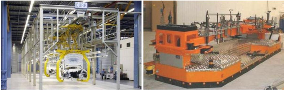
Abbildung 35 Hubgehänge (links) und Beispiel einer Schubplattform (rechts)
