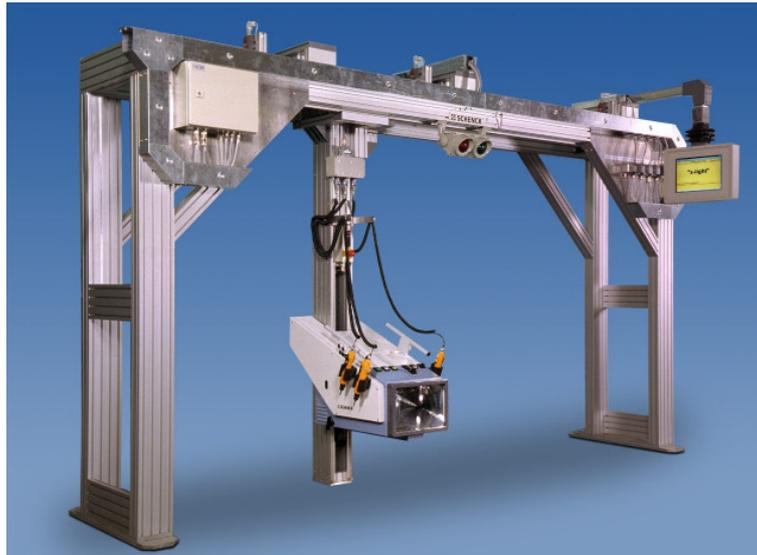
Abbildung 9 Portal eines Scheinwerfereinstellstandes ‚x-light‘ mit Lichtkasten und Einstellschrauben für Nebel- und Hauptscheinwerfer /15/
