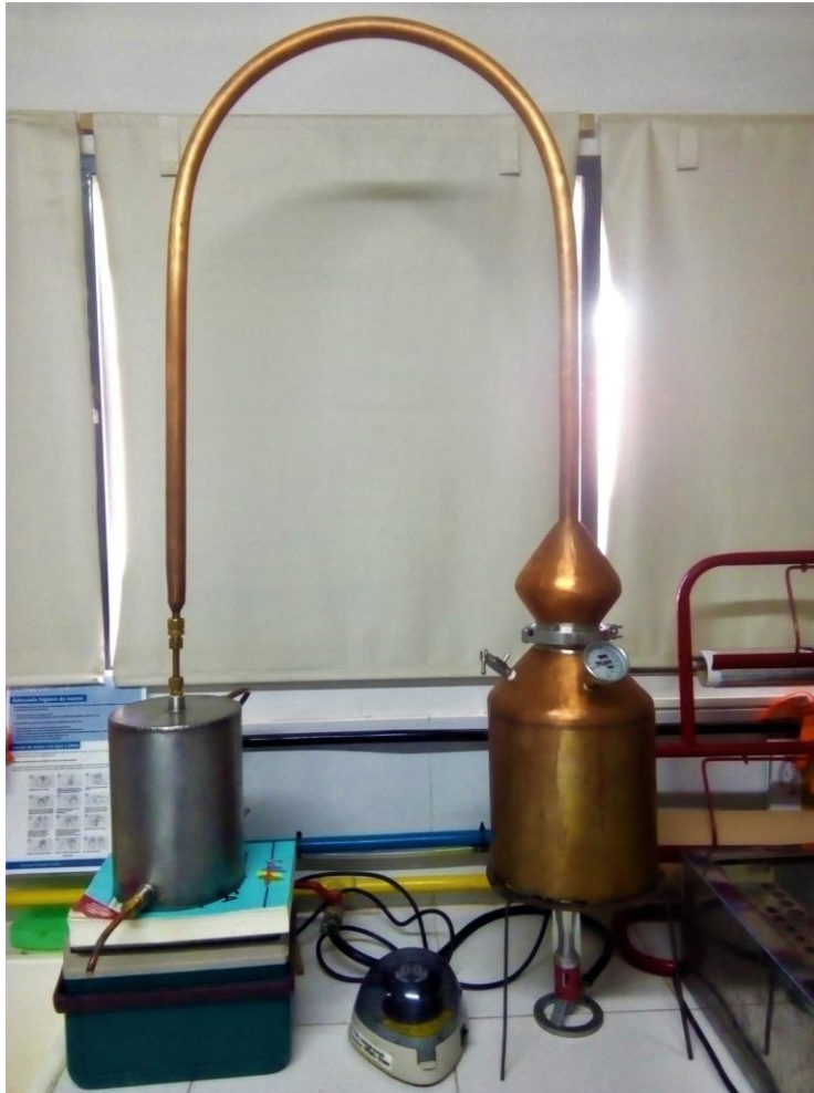
Figura 3: Alambique artesanal de cobre utilizado para la destilación de las fermentaciones.
