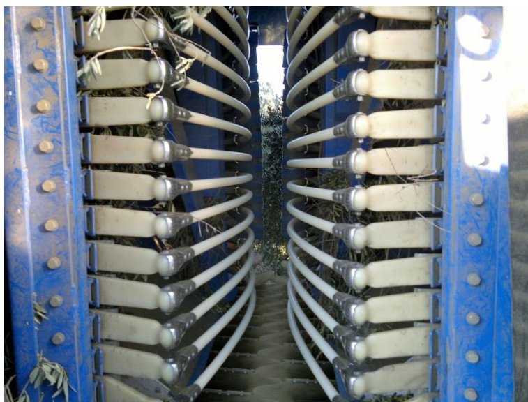
Fig. 1.2.1. – Sacudidores da máquina Braud - New Holland no olival da empresa Olivais do Sul, 2017
