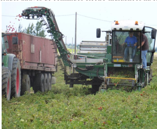
Fig. 2.2.20 – Transportador elevador de descarga numa máquina MTS-Sandet. Herdade do Falcão (Évora) – 2014
