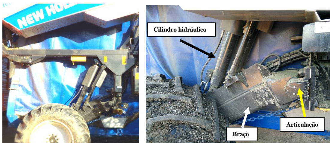
Fig. 1.1.5 – Braço articulado da roda traseira direita, actuado por cilindro hidráulico. Visita de estudo aos Olivais do Sul, 2016 e 2017
