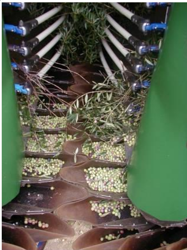
Fig. 1.2.18 - Transportador contínuo de godés deformáveis Máquina Braud New Holland na Quinta de Vale de Lobos (Ribatejo)
