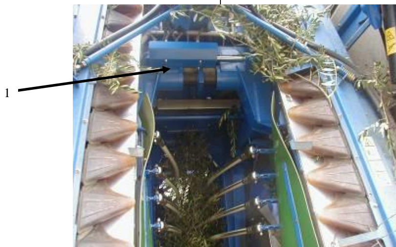
Fig. 1.2.10 – Máquina Braud New Holland na Quinta de Vale de Lobos (Ribatejo) 2003 1 – Cilindro hidráulico para regular folga entre os corpos da máquina de vindimar
