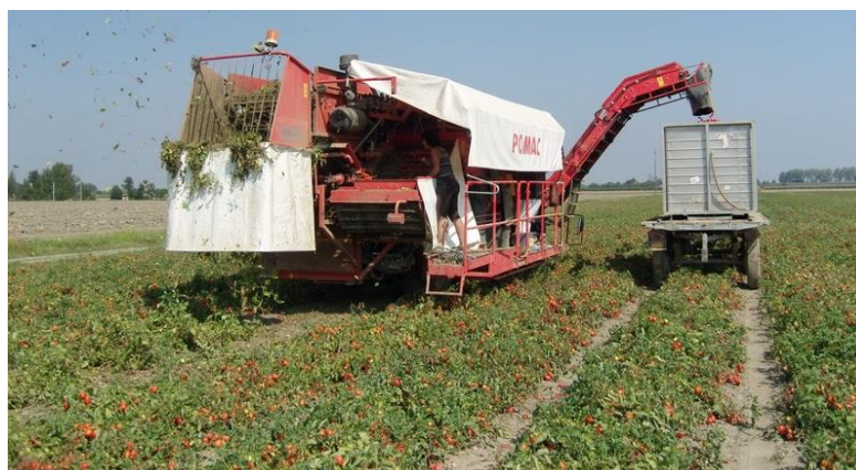
Fig. 2.2.11 - Saída da rama na parte posterior (Máquina POMAC)
