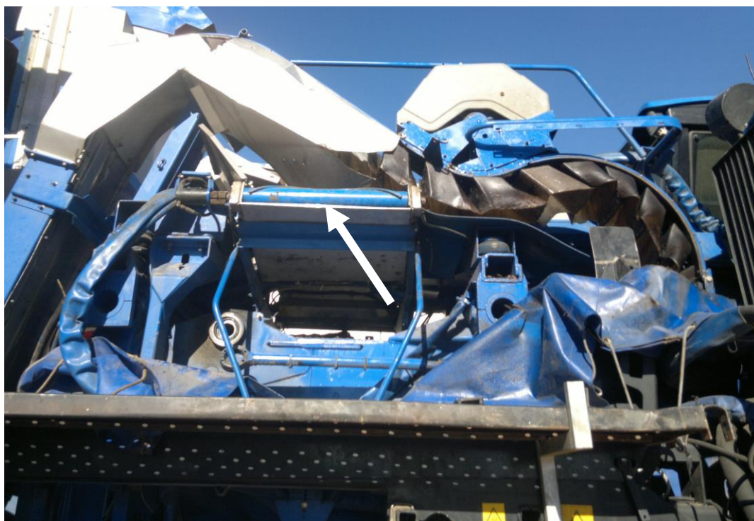
Fig. 1.2.20 - Transportador contínuo transversal direito Máquina Braud New Holland na Herdade de Torre das Figueiras (Monforte)
