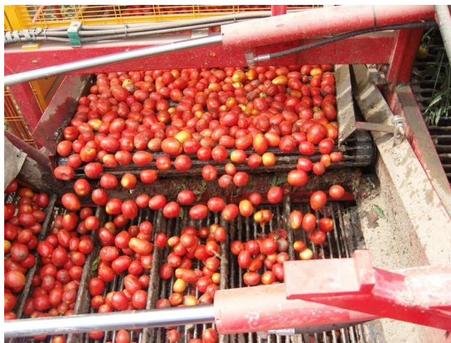
Fig. 2.2.13 – Tomate já seleccionado e limpo a ser transferido para o transportador de descarga (Máquina POMAC)
