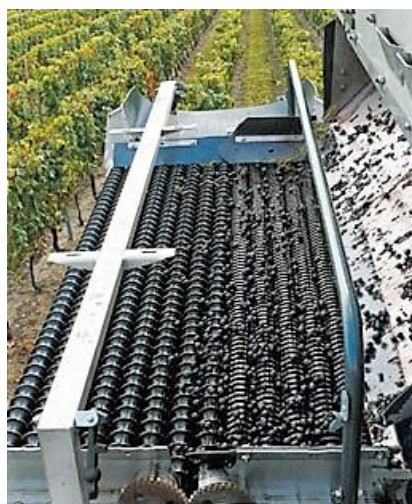
Fig. 1.2.26 – Crivo de roletes para limpeza http://www.pellenc.com/
