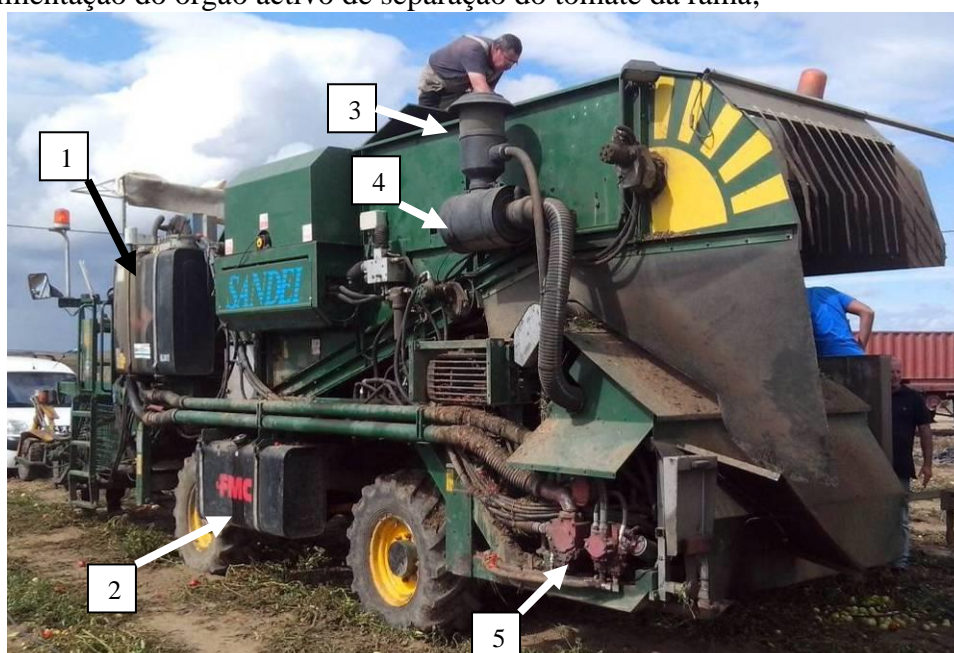
Fig. 2.2.2 – Máquina MTS – Sandet: (1) Reservatório do óleo do sistema hidráulico; (2) Depósito de combustível; (3) Pré filtro de ar do motor Diesel; (4) Filtro de ar seco do motor Diesel; (5) Bombas do sistema hidráulico. Herdade do Falcão (Évora) - 2014
