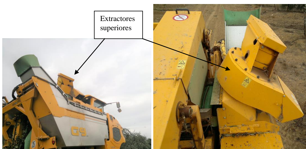
Fig. 1.2.23 – Extrator de limpeza superior de uma máquina Gregoire. Torre das Figueiras, 2017
