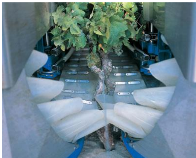
Fig. 1.2.19 – Godés fechando-se em torno de uma cepa. http://www.newholland.com/
