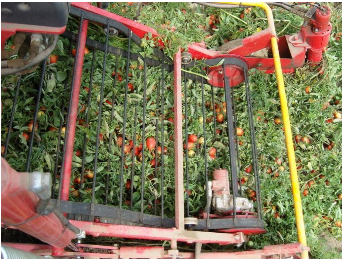
Fig. 2.2.6 – Transportador elevador da cultura de uma máquina POMAC .
