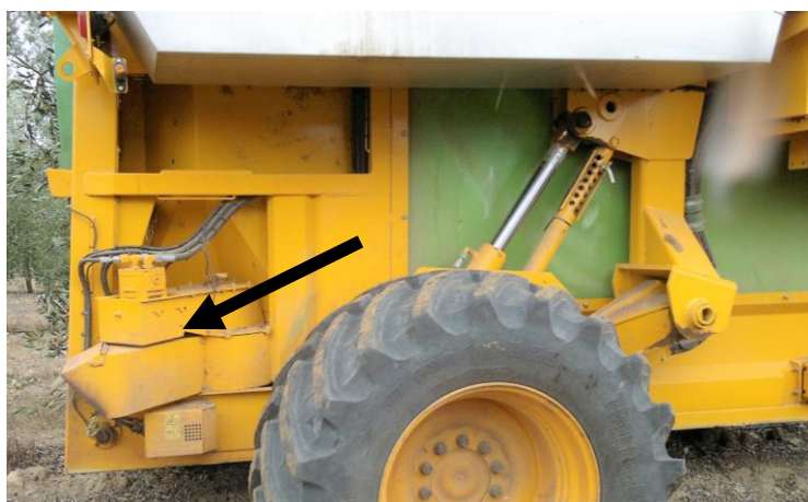
Fig. 1.2.24 – Extrator de limpeza inferior na traseira de uma máquina Gregoire. Torre das Figueiras, 2017
