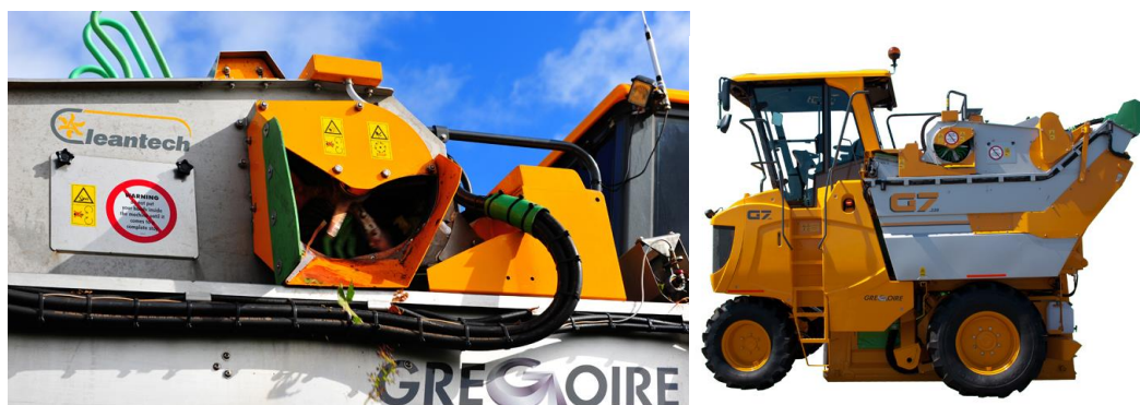
Fig. 1.2.28 – Sistema de limpeza e para desengaçar http://www.gregoire.fr
