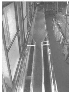
Figura 10. Canal de laboratorio de 0.6m de ancho y 12 m de largo, con arena de cuarzo casi uniforme, en el Laboratorio de Hidráulica del Departamento de Ingeniería Ambiental, Universidad de Génova. (En esta figura el ancho del tramo aguas arriba del canal es delgado de 0.2m, la relación de ampliación es igual a 3)
