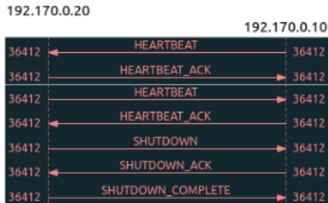
Figura 3. 41. Diagrama de secuencia: fin de conexión entre MME y eNB. Por los autores.
