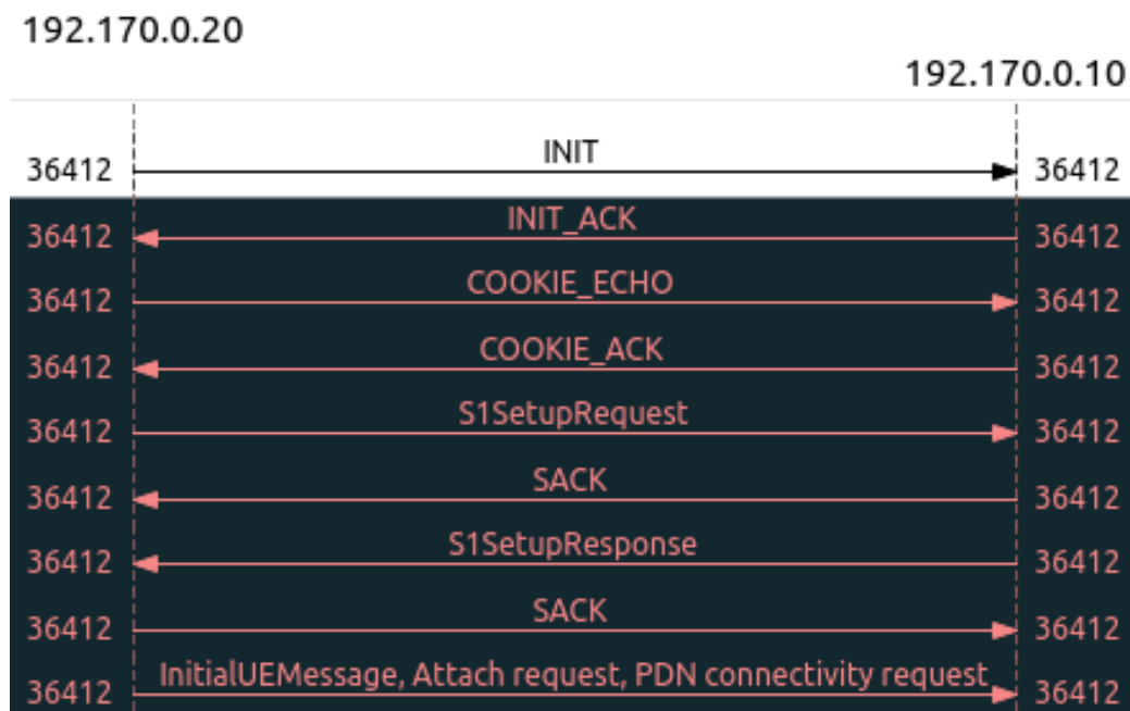
Figura 3. 30. Diagrama de secuencia: Conexión entre MME y eNB. Por los autores.
