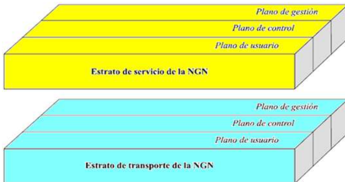
Figura 2. Modelo de referencia básico de la NGN. Basado en [6].
