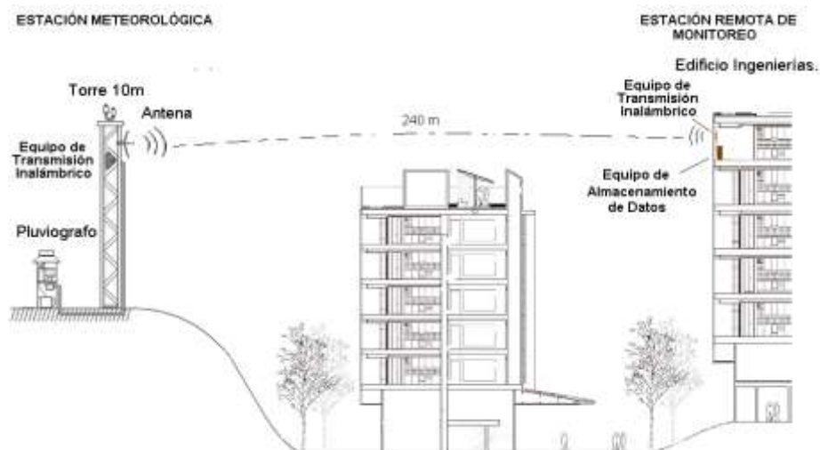
Figura 4.2. Instalación de Equipos inalámbricos.
