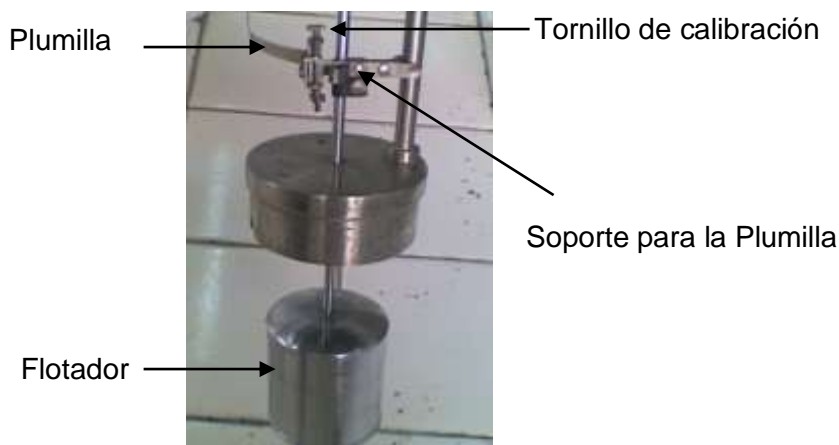
Figura 6.1 Sistema de Flotador y Plumilla de un Pluviógrafo tipo Hellman.
