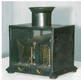
Figura 1.1 Pluviógrafo de Benedetto Castelli.
