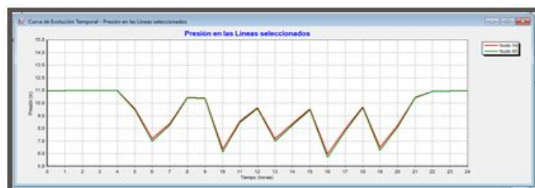
Figura 27. Curva de la presión en los puntos más desfavorables del Sitio San Vicente
