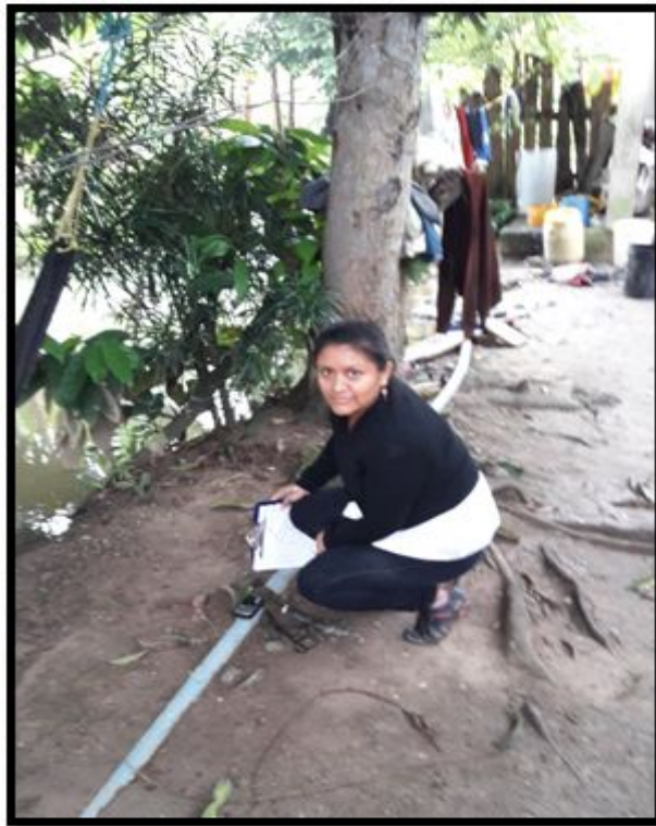
Anexo 1. Identificación de la tubería mediante GPS
