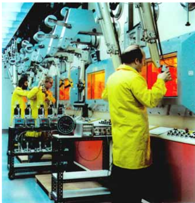
Heiße Zellen, Bedienseite mit Manipulatoren für fernbedientes Arbeiten
