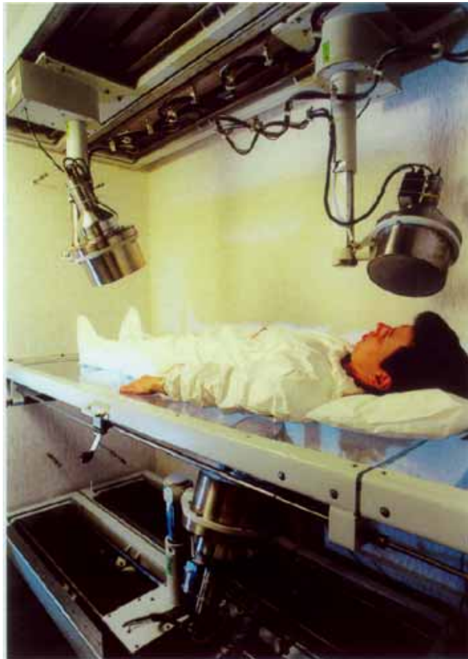
Ganzkörperzähler des Forschungszentrums Karlsruhe zur Bestimmung gammastrahlender Radionuklide im menschlichen Körper
