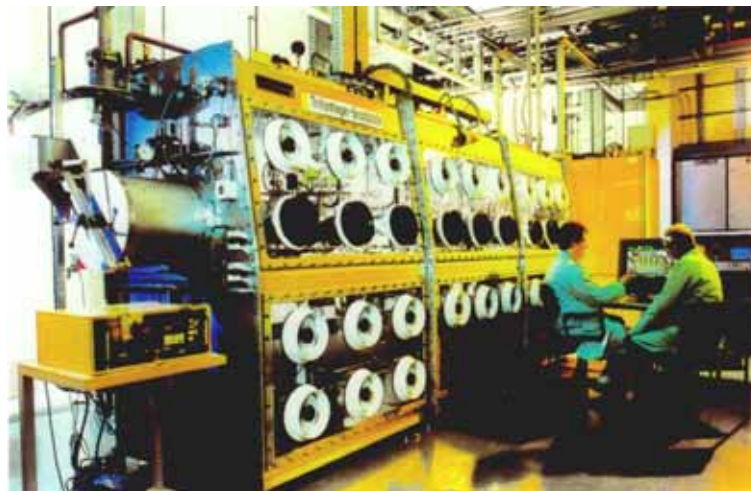
Labor zur Handhabung von gasförmigen Tritium in einer Reihe von Handschuhkästen
