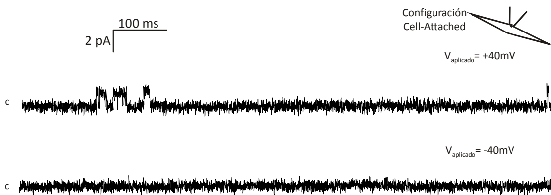
Figura 3.1.9: Registro típico del canal del grupo 5 de actividad dependiente del voltaje. c indica el nivel de corriente del estado cerrado del canal.
