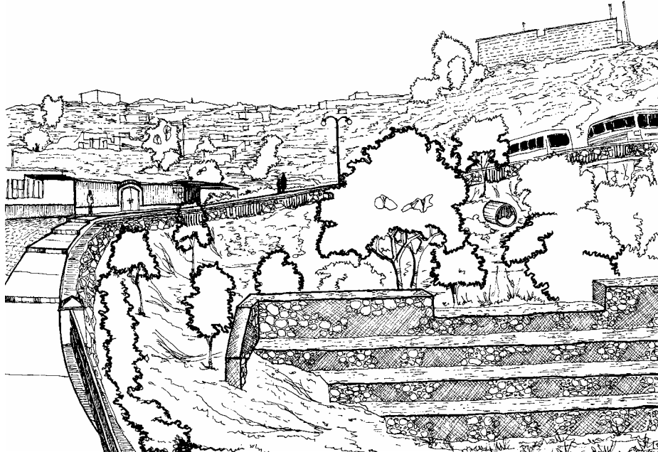
Imagen 9.8.1.B. Propuesta de presas de retención de azolves
