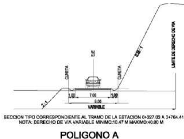
Fig. II.13. Secciones tipo del camino
