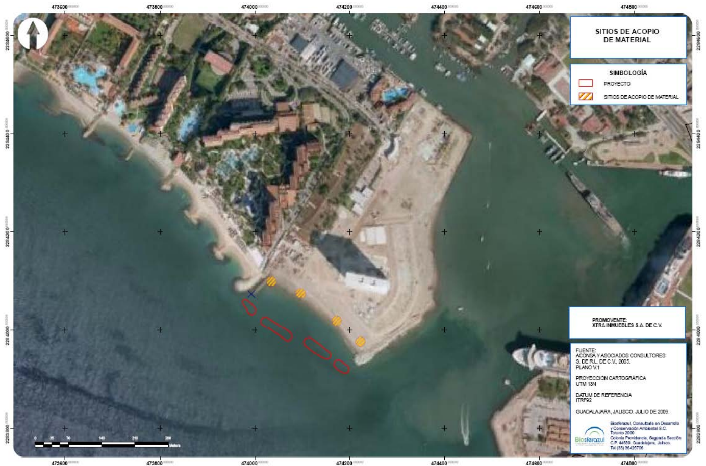
Figura II.6. Sitios de acopio de material en el frente de playa
