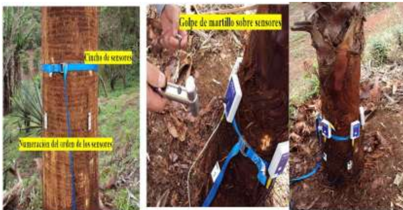
Fig. 3. Método de instalación de sensores y lectura de señales.
