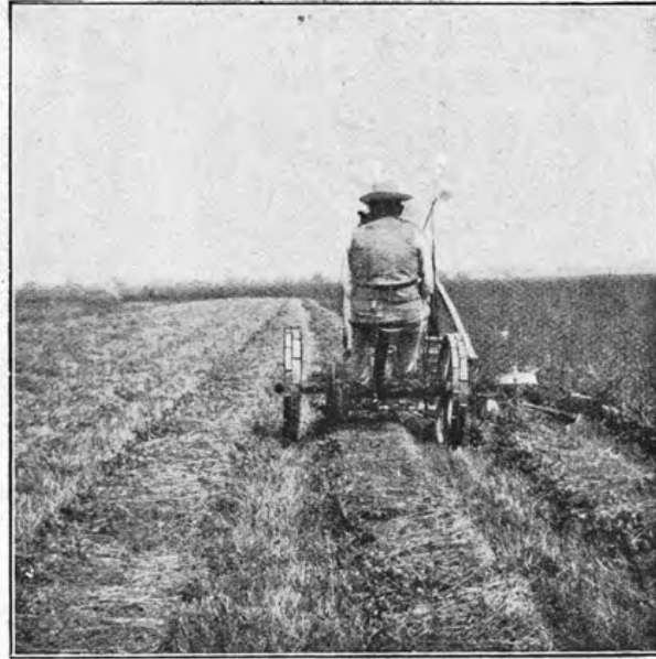
Fig. 186. Perrottscher Schwadlegeapparat für Grasmähmaschinen von Carl Jenisch (Berlin-Wilmersdorf). Text auf Seite 181.
