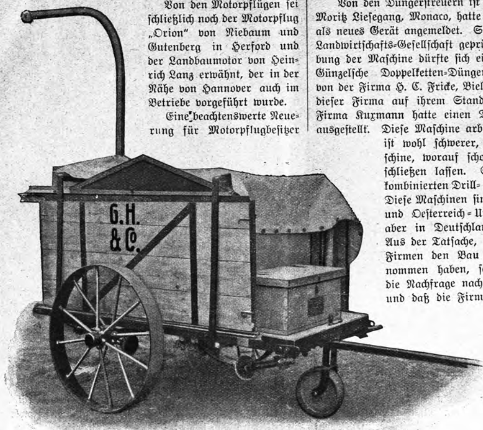
Fig. 179. Der Ginzelsche Weiwagen für Motorpflüge mit der zerlegten Wohnhütte, zum Transport hergerichtet. — Text auf Seite 169.
