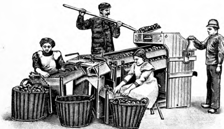
Fig. 240. Reinigungs- und Sortiermaschine „Federkraft“ mit Ausleseapparat von H. Dreher in Gaste (Hannover.) Text auf Seite 241
