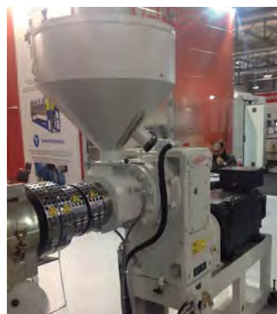
Rys. 2. Uniwersalny korpus umożliwia łatwą instalację napędu w dowolnej pozycji montażowej
