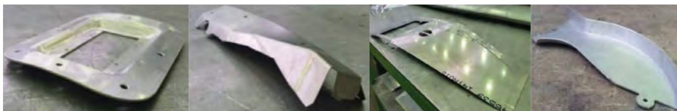
Rys. 1. Przykłady wyrobów tłoczonych stemplami elastycznymi
