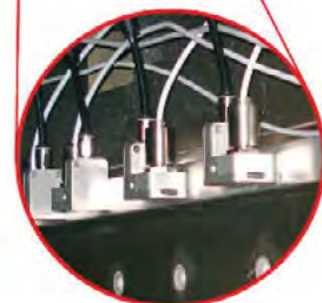
Rys. 3. Stały monitoring temperatury na kalandrze wytłaczającym wykonywany przez termometr na podczerwień optris CT LT
