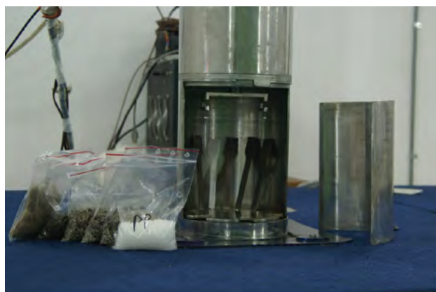
Fot. 4. Granulaty PP i kompozytów PP/konopie oraz uformowane wypraski oraz komora do napromieniowania źródła promieniowania gamma GC 5000
