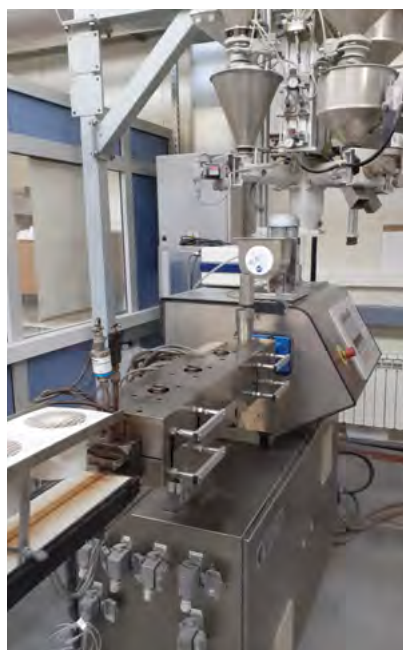
Fot. 1. Laboracyjne stanowisko do wytwarzania kompozytów polimerowych wyposażone w wylączarkę dwuślismakową współbieżną Bühler
