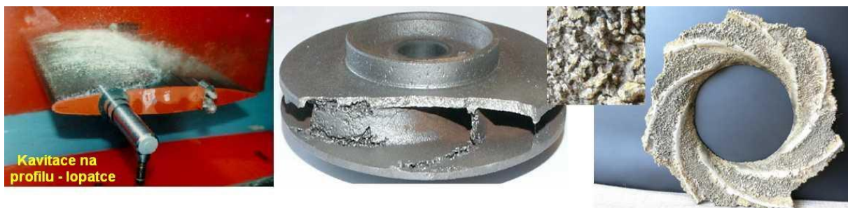
Obr. 14.28 Oběžné kolo čerpadla poškozené kavitací
