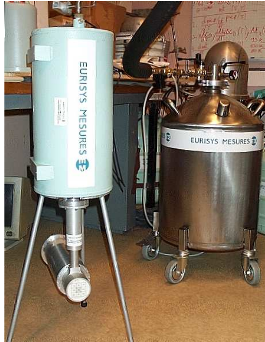
FIG. 3.12: Photographie de l'ensemble cryostat+détecteur.
