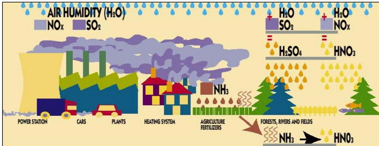
Σχήμα 2.7. Το διοξείδιο του θείου ( \text{SO}_2 ) και τα οξείδια του αζώτου ( \text{NO}_x ) συνενώνονται με μόρια νερού και σχηματίζονται θειικό και νιτρικό οξύ.
