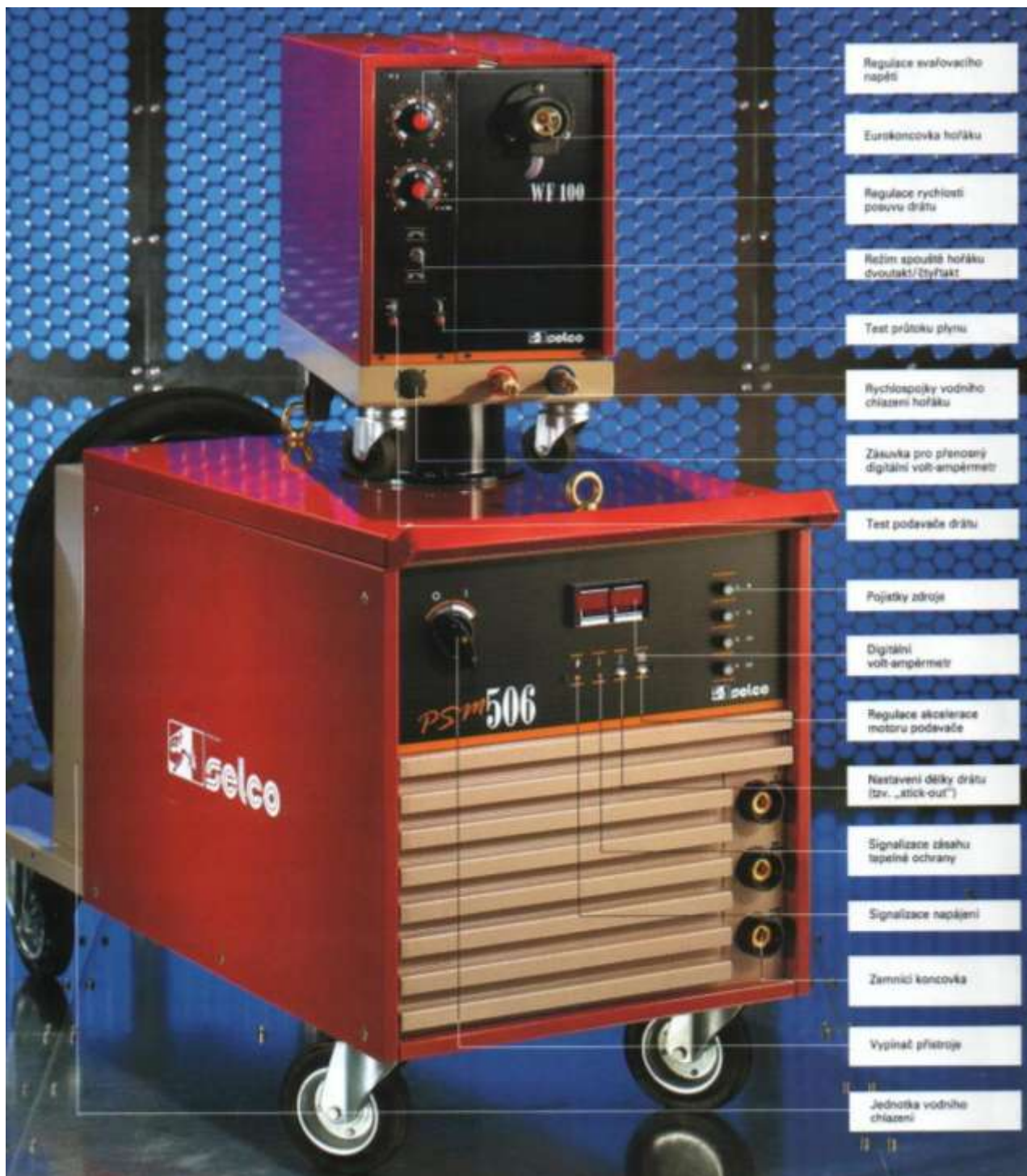
Obr. 93 Poloautomatický systém PSM 506 firmy SELCO pro svařování metodami MIG/MAG
