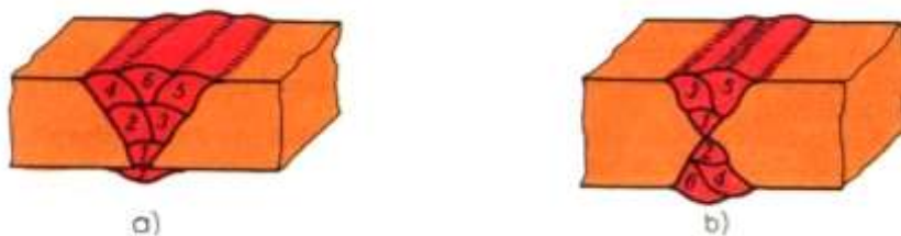
Obr. 115 Postup při svařování tlustých materiálů
