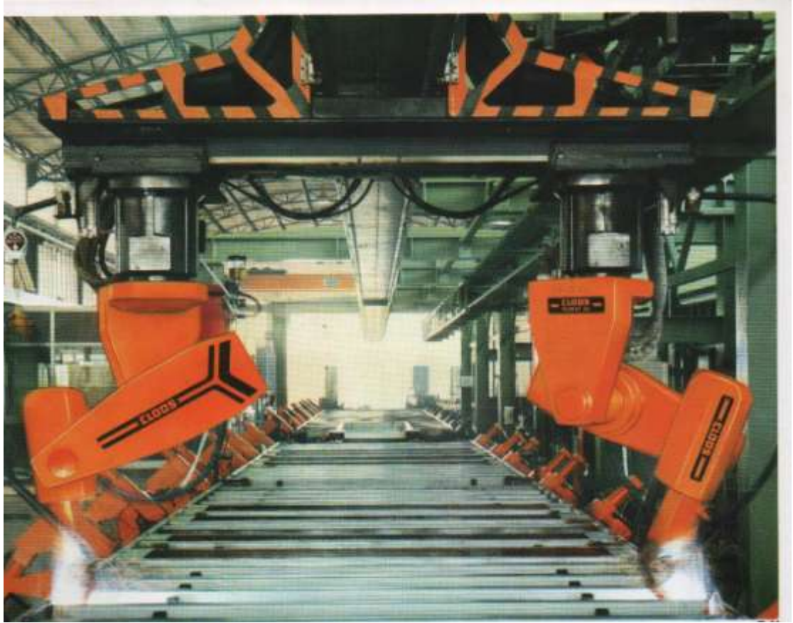
Obr. 94 Portálové robotické pracoviště ROMAT 56 pro svařování kontejnerových podlah firmy Cloos
