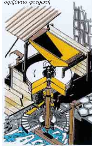
ΕΙΚ. 14: Κάτοψη νερόμυλου με οριζόντια φτερωτή
