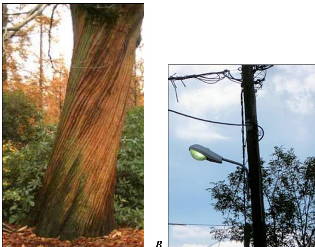
ΕΙΚ. 25. Α) Στρεψοΐνια σε ιστάμενο κορμό καστανιάς. Β) Εμποτισμένοι στύλοι ηλεκτρισμού (βλ. κορμό πεύκης: στον οποίο συχνά διακρίνουμε σφάλμα στρεψοΐνιας).
