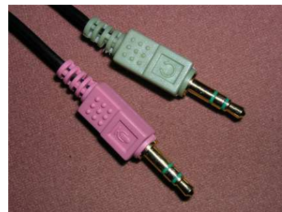
Εικόνα 2: Βύσματα σύνδεσης ακουστικών και μικροφώνου.
