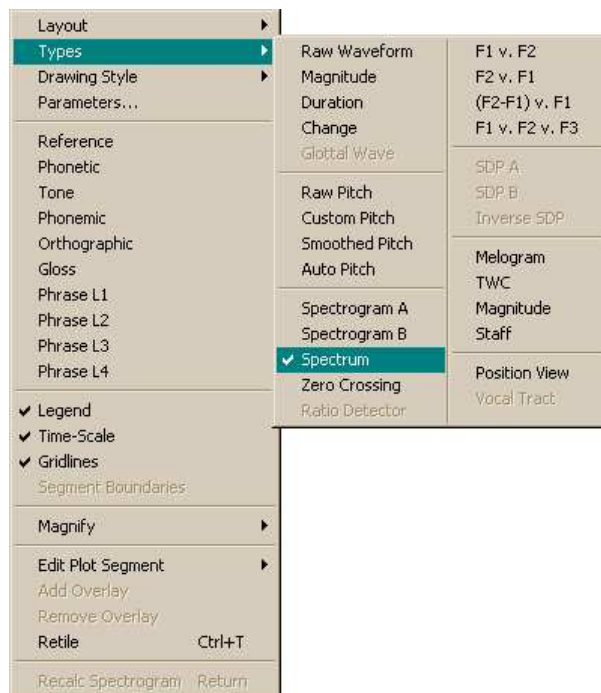
Εικόνα 52: Κατάλογος επιλογών τύπων απεικόνισης, με επιλεγμένο τον τύπο Spectrum για τον αυτόματο υπολογισμό και απεικόνιση του φάσματος.
