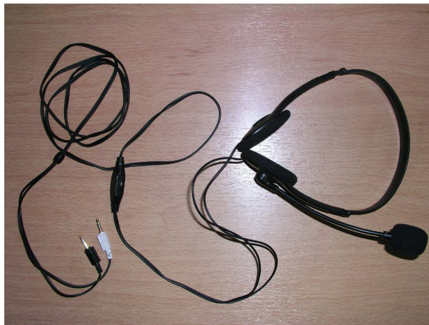
Εικόνα 1: Ακουστικά με ενσωματωμένο μικρόφωνο και ρυθμιστή έντασης, κατάλληλα για πρόχειρες ηχογραφήσεις και παρακολούθηση των ακουστικών αναλύσεων.
