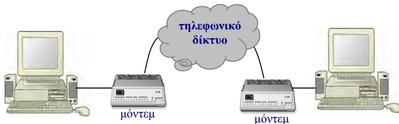
Σχήμα 6.4.1 Τα μόντεμ ακουστικών συχνοτήτων μπορούν να συνδέσουν δύο υπολογιστές χρησιμοποιώντας το τηλεφωνικό δίκτυο.
