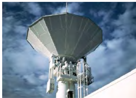
Σχήμα 8.4.5: Κεραία δορυφορικής λήψης του δικτύου ICO. Οι συχνότητες που θα χρησιμοποιούνται στο δίκτυο ICO θα είναι για τη ζεύξη των επίγειων σταθμών με τους δορυφόρους τα 5 GHz για την ανερχόμενη ζεύξη και 7 GHz για την κατερχόμενη ζεύξη (ζώνη C). Επίσης για την επικοινωνία των συνδρομητών με τους δορυφόρους θα χρησιμοποιούνται οι περιοχές 1980-2010 MHz για την κατερχόμενη και 2170-2200 MHz για την ανερχόμενη ζεύξη.
