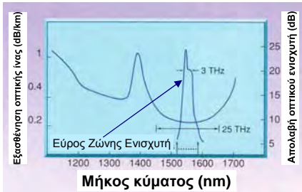
Σχ. 4.6.1. Η εξασθένιση στην οπτική ίνα έχει ένα ελάχιστο σε μήκος κύματος 1550 nm, περιοχή στην οποία οι ενισχυτές ίνας προσμείξεων ερβίου εμφανίζουν τη μέγιστη απολαβή τους.
