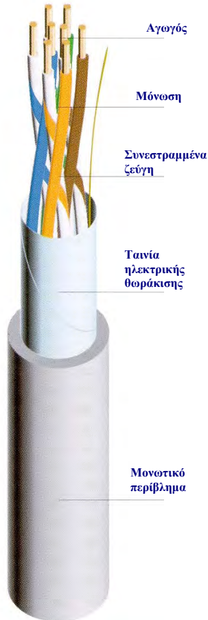
Σχήμα 3.1.1: Θωρακισμένο καλώδιο με πολλαπλά συνεστραμμένα ζεύγη χάλκινων αγωγών
