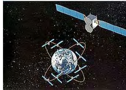
Σχήμα 8.4.4: Το δίκτυο δορυφόρων της ICO. Οι δορυφόροι θα συνδέονται με 12 επίγειους σταθμούς, κάθε ένας από τους οποίους θα έχει 5 κεραίες για τη συνεχή παρακολούθηση της πορείας τους.
