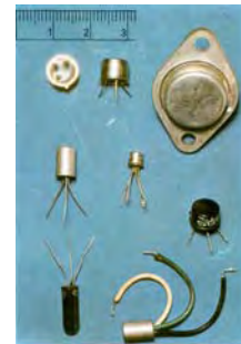
Σχ. 4.1.2. Διάφορα είδη τρανζίστορ και αντιστοιχία διαστάσεων σε χιλιοστομετρική κλίμακα.
