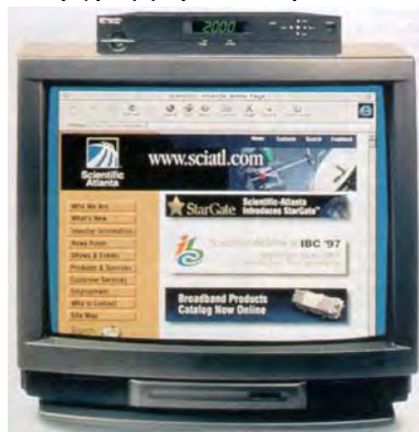
Σχήμα 9.6.2 Στη φωτογραφία φαίνεται η συσκευή STB τοποθετημένη πάνω στον τηλεοπτικό δέκτη. Η συσκευή STB μπορεί να χαρακτηριστεί «υβριδική», εφόσον περιέχει ένα υπολογιστή και ένα μόντεμ. Δίνει τη δυνατότητα «πλοήγησης» στο διαδίκτυο με ένα τηλεχειριστήριο. Μπορεί επίσης να συνδεθεί και με όλες τις οικιακές ηλεκτρονικές συσκευές εικόνας και ήχου. Για παράδειγμα μπορεί να κατευθύνει τη μουσική από το διαδίκτυο στο στερεοφωνικό συγκρότημα ή την εικόνα από τη βιντεοκάμερα σε άλλον συνδρομητή.
