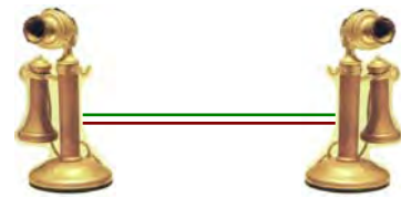
Σχήμα 7.1.1 Άμεση σύνδεση δύο συνομιλητών
