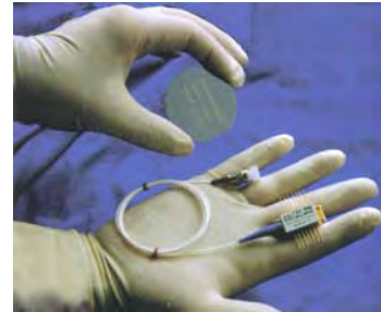
Σχ. 4.4.9. Συσκευασμένο laser ημιαγωγού με προσαρτημένη την οπτική ίνα. Φαίνεται επίσης το ημιαγωγικό δισκίο από το οποίο προήλθε το laser.
