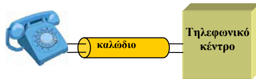
Σχήμα. 6.1.1 Το τηλέφωνο συνδέεται με το κέντρο με καλώδιο που περιέχει δύο αγωγούς.
