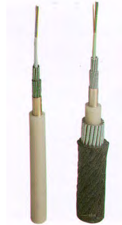
Σχήμα 3.5.2 : Δείγμα υποβρυχίων οπτικών καλωδίων. Για να τροφοδοτούνται με ρεύμα οι οπτικοί ενδιάμεσοι ενισχυτές, το υποβρυχίο καλώδιο, περιλαμβάνει και χάλκινους αγωγούς
