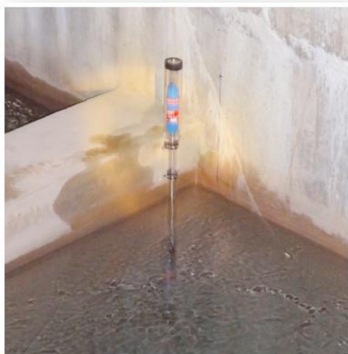
Fig. 4.8: Sensore di livello idrico e datalogger installato nella vasca di laminazione del partitore, a monte dello stramazzo.
