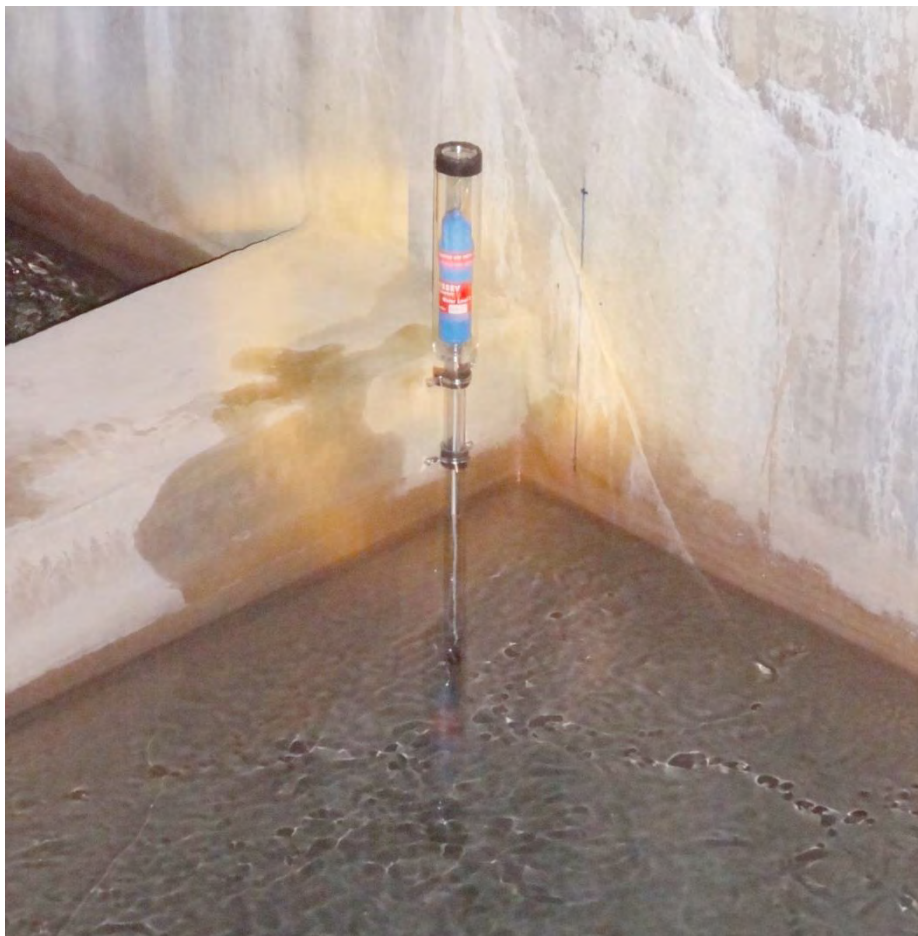
Fig. 4: Sensore di livello idrico e datalogger installato nella vasca di laminazione della sorgente inferiore, posta a valle dell'ingresso dei deflussi provenienti dalla sorgente superiore, ed a monte dello stramazzo.
