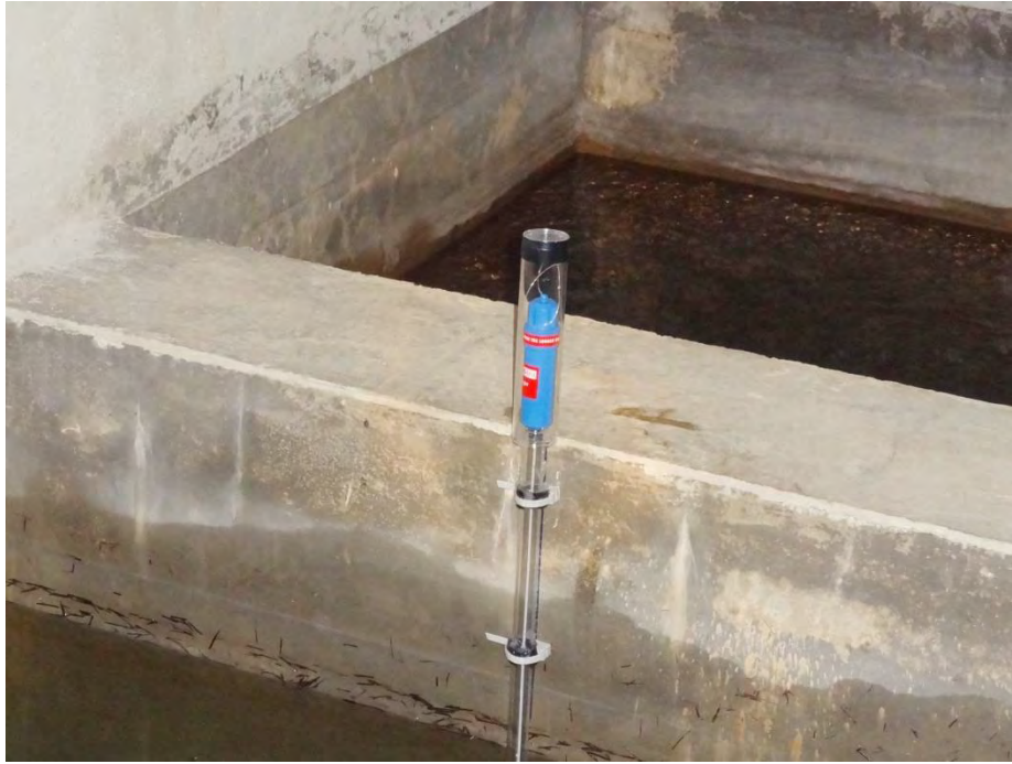
Fig. 3: Sensore di livello idrico e datalogger installato nella vasca di laminazione del partitore, a monte dello stramazzo.
