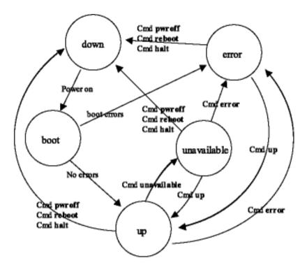
Figure 1-8. Node State Transition Diagram
