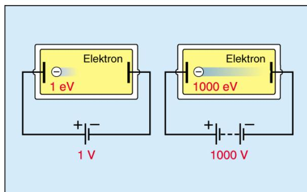
Veranschaulichung der Energieeinheit Elektronvolt
