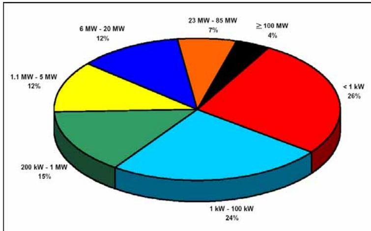
Prozentuale Verteilung der thermische Leistung der weltweit in Betrieb befindlichen Forschungsreaktoren, IAE0 2004
