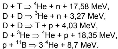
Die Deuterium-Tritium-Reaktion ist unter allen möglichen Fusionsreaktionen noch am leichtesten zu verwirklichen. Deuterium ist in genügender Menge in den Weltmeeren vorhanden; Tritium kann aus dem ebenfalls reichlich verfügbaren Element Lithium mit Hilfe der beim Fusionsprozess entstehenden Neutronen „erbrütet“ werden. Brutreaktionen zur Erzeugung von Tritium aus Lithium:
