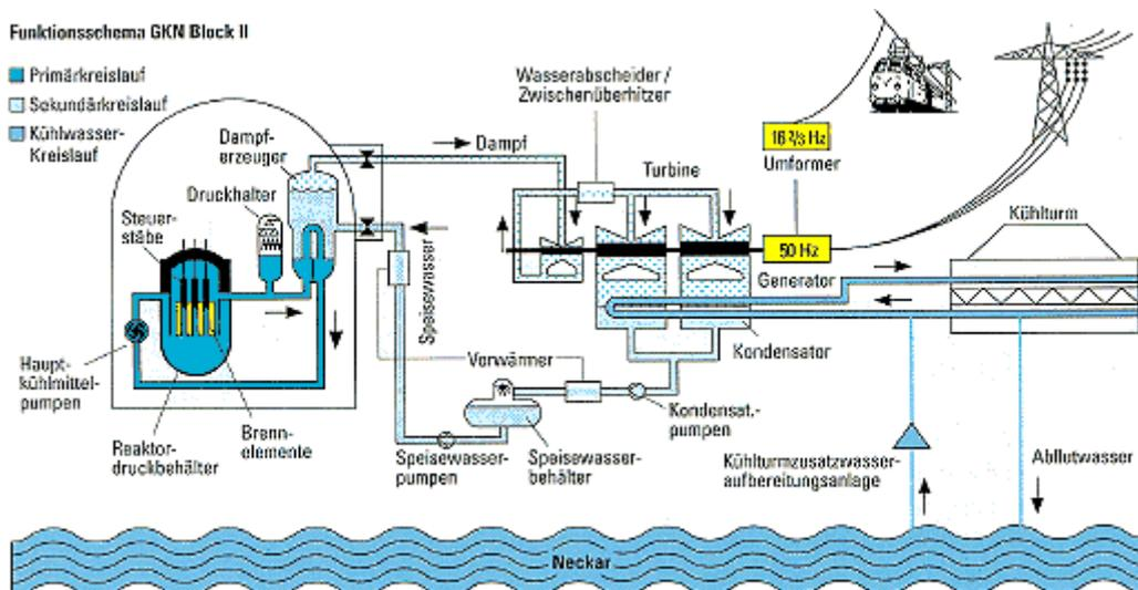
Funktionsschema GKN-2, Turbogenerator für 50 Hz Drehstrom für die öffentliche Versorgung und Umformer für 16⅔ Hz Bahnstrom
