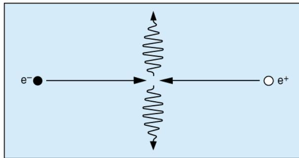
Auftreten von Vernichtungsstrahlung beim Aufeinandertreffen von Elektron und Positron. Es entstehen zwei Gammaquanten von jeweils 0,511 MeV
