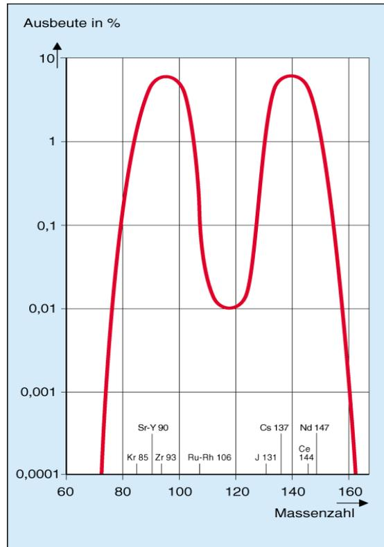
Spaltausbeute, Summe der Ausbeuten aller Nuklide mit einer bestimmten Massenzahl bei Spaltung von U-235 durch thermische Neutronen in Abhängigkeit von den Massenzahl
