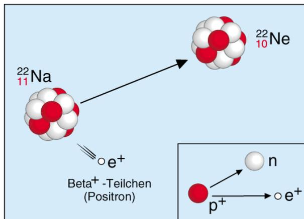
Beta-Plus-Zerfall (Beta<sup>+</sup>-Zerfall,  $\beta^+$ -Zerfall); Zerfall von Na-22 in Ne-22 unter Aussendung eines Positrons (Beta<sup>+</sup>-Teilchen,  $\beta^+$ -Teilchen)
