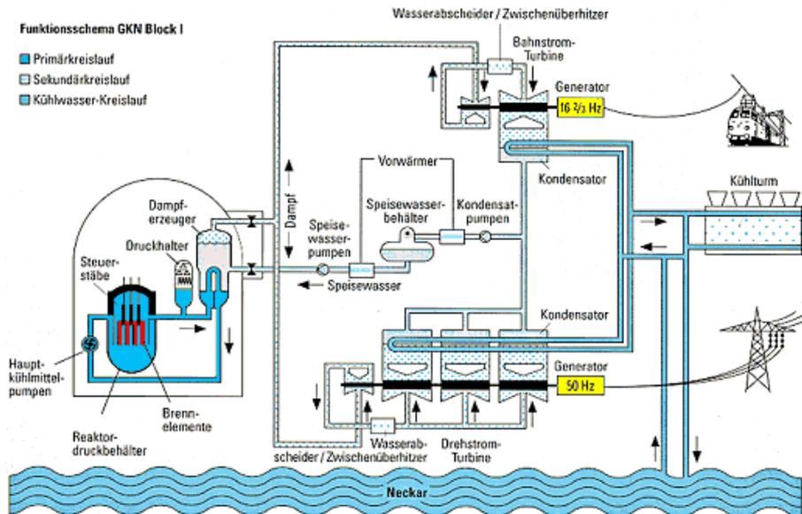
Funktionsschema GKN-1, ein Turbogenerator für 16⅔ Hz Bahnstrom und ein Turbogenerator für 50 Hz Drehstrom für die öffentliche Versorgung
