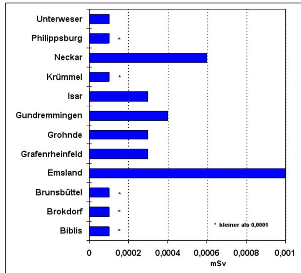
Strahlenexposition für Erwachsene am ungünstigsten Punkt in der Umgebung von Kernkraftwerken durch die Emission radioaktiver Stoffe mit dem Abwasser, 2007
