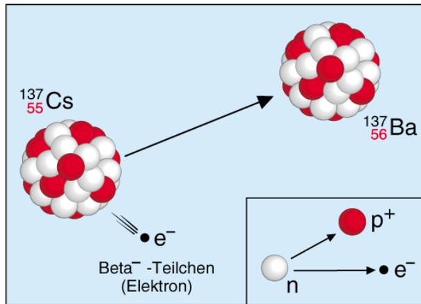
Beta-Minus-Zerfall (Beta<sup>-</sup>-Zerfall,  $\beta^-$ -Zerfall). Zerfall von Cs-137 in Ba-137 unter Aussendung eines Elektrons (Beta<sup>-</sup>-Teilchen,  $\beta^-$ -Teilchen)
