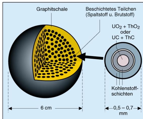
Schematische Darstellung der Brennstoffkugel des Kugelhaufen-Reaktors
