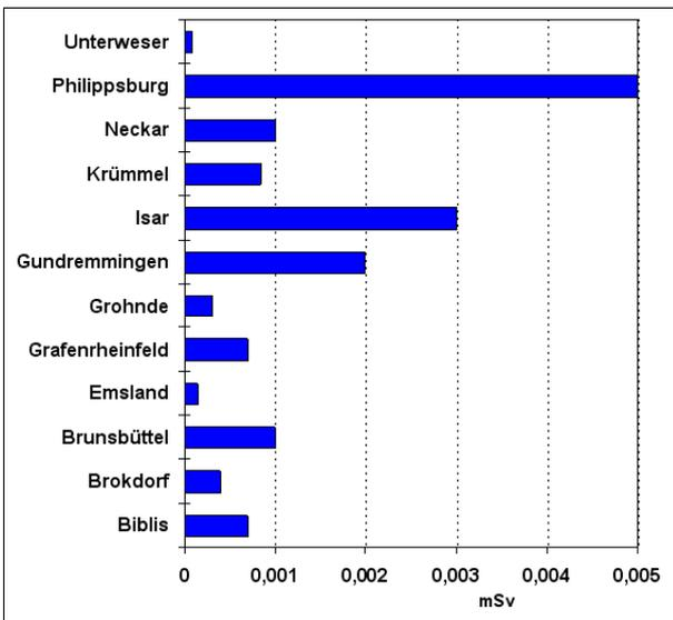
Strahlenexposition für Erwachsene am ungünstigsten Punkt in der Umgebung von Kernkraftwerken durch die Emission radioaktiver Stoffe mit der Abluft, 2007
