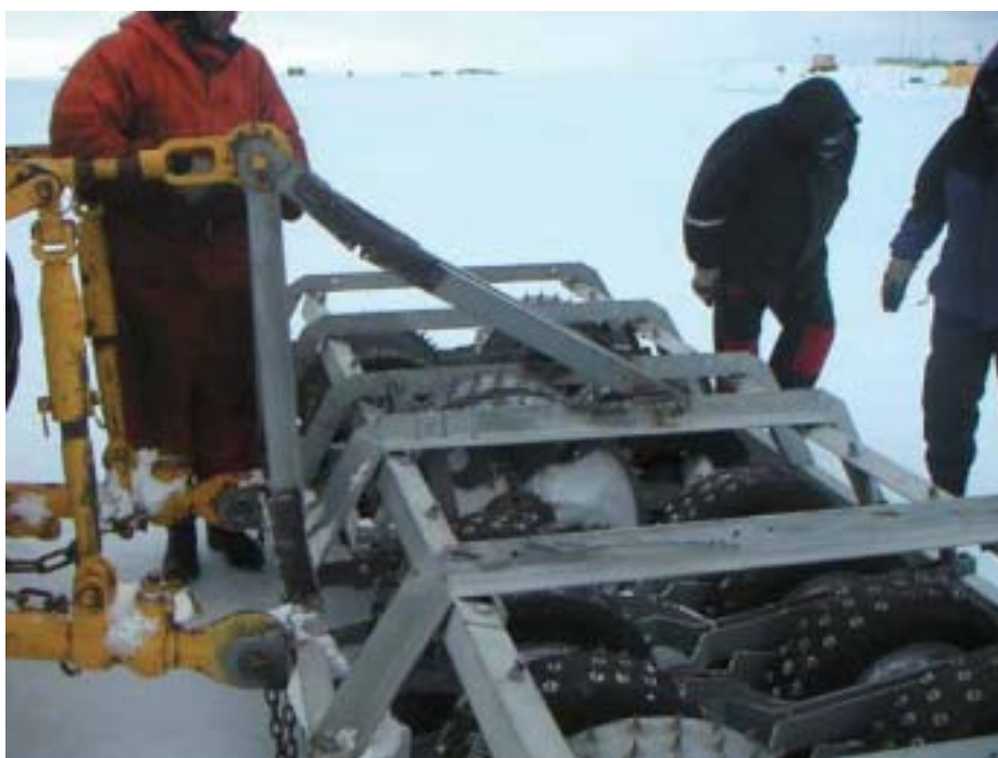
Рис. 2.2.3. Испытания прицепного катка для обработки льда
