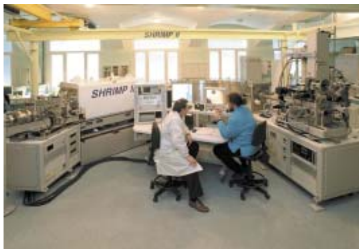
Рис. 1.4.6. Ионный микрозонд высокого разрешения SHRIMP-II (Центр изотопных исследований ВСЕГЕИ),
