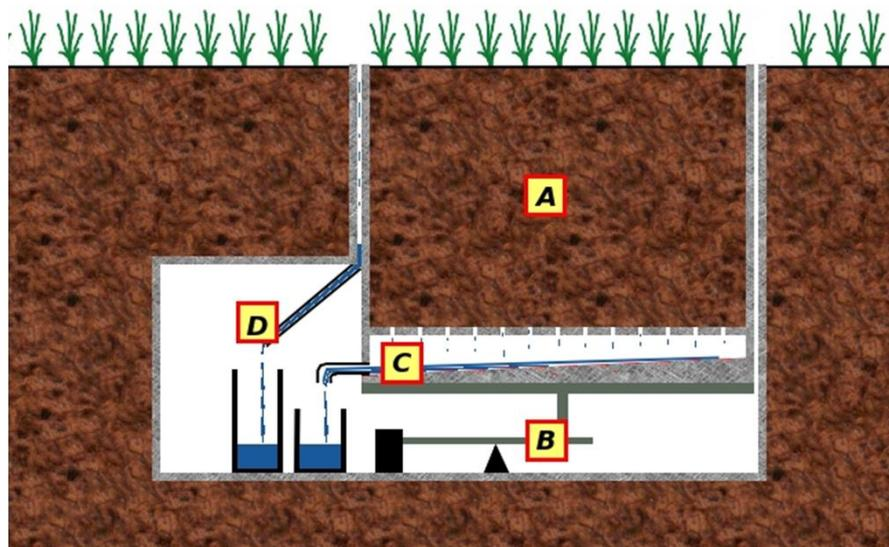
**Modello schematico di un lisimetro a pesata**
