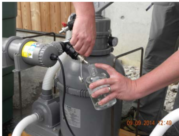
Obr. 2: Odběr vzorků vody za UV-sterilizátorem pomocí ventilu na T-kusu
