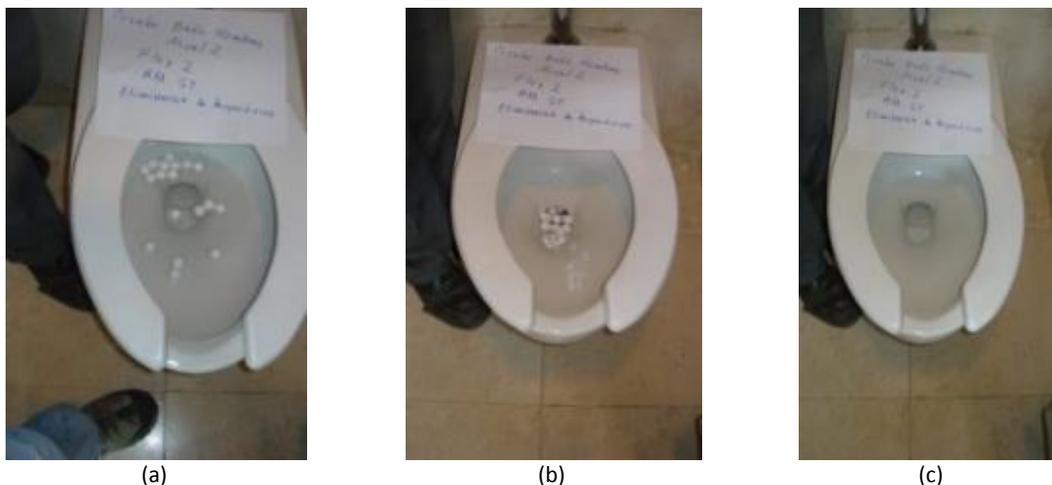
Figura 4. Prueba de exclusión de residuos. (a) Preparación, (b) Realización, (c) Resultado
