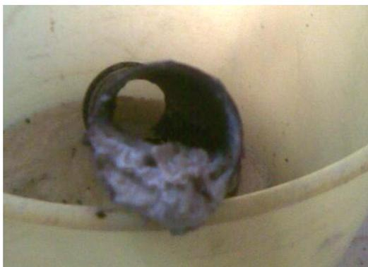
Figura 8. Incrustación en una tubería.
