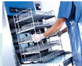
自動洗浄・消毒装置
