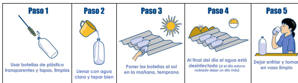
Figura 8. Los 5 pasos para obtener agua potable mediante el proceso SODIS
