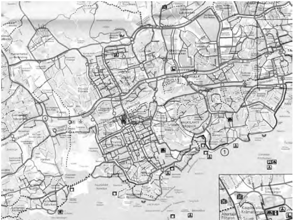
Σχ. 4.8. Κυκλοφοριακή επίλυση της περιοχής Tapiola: Κυψέλες εσωτερικής κυκλοφορίας (Δοξιάδης, Buchanan 1960) σε σχέση με τις μεγάλες υπερτοπικές αρτηρίες, φαίνονται καθαρά οι δρόμοι εσωτερικής κυκλοφορίας των κυψελών που είναι όλοι θηλειές ή αδιέξοδα.
