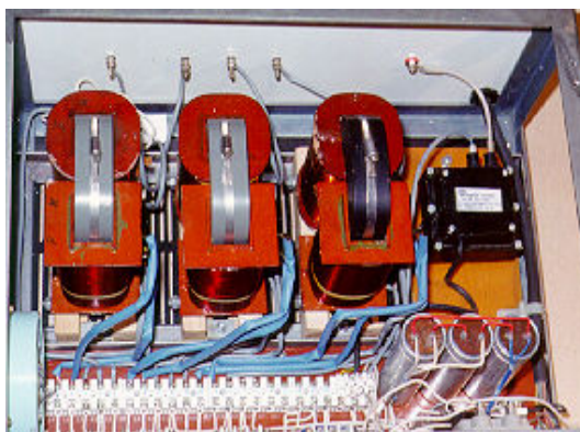
Rys. 4.5. Zdjęcie wnętrza zasilacza zintegrowanego o mocy 5kW
