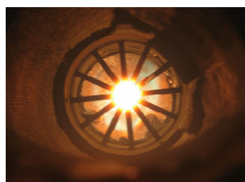
Rys. 3.11. Wnętrze komory wyładowczej dwunastoelektrodowego reaktora plazmowego [120]
