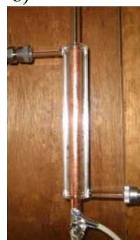
Rys. 6.2. Ozonator z elektrodą śrubową chłodzoną wodą (a), b) zdjęcie ozonatora laboratoryjnego
