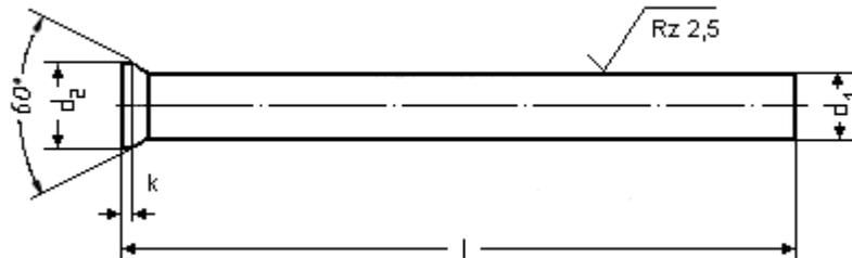
Die Schneidstempel / Lochstempel nach DIN 9861 (ähnlich ISO 6752) werden hauptsächlich in Schnitt- und Stanzwerkzeugen eingesetzt. Der Schaft sowie der gesamte Kopf sind feinstgeschliffen.
