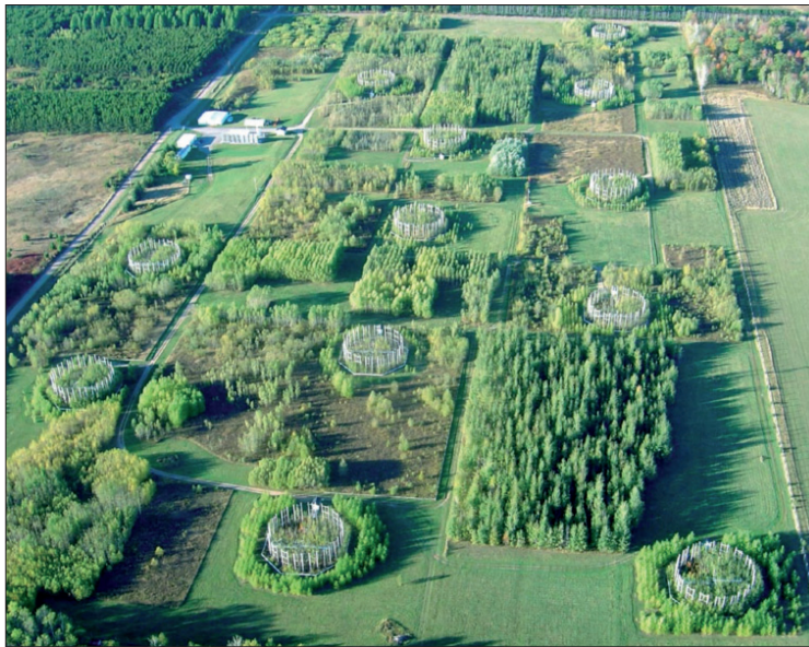
Figura 3.6 Esperimenti di manipolazione di ecosistemi con livelli elevati di CO 2 atmosferica (FACE, free air carbon enrichment).
