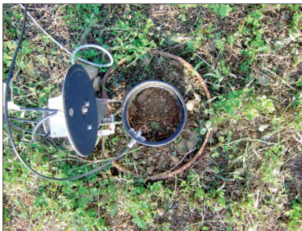
Figura 4.10 Root exclusion per separare la respirazione eterotrofica da quella totale. In questo caso, un cilindro metallico aperto da entrambe le estremità è inserito nel terreno per impedire la crescita delle radici al di sotto della cameretta.
