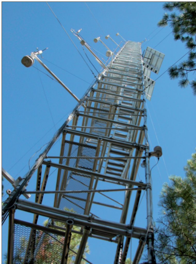
Figura 4.5 Torre di misura Eddy Covariance .
