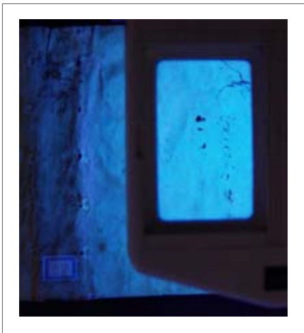
Inspección con luz ultravioleta del estado de los elementos gráficos de las cubiertas
