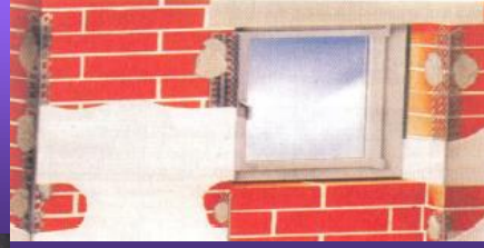
Sıva profilleri ve sıva filesi üzerinde uygulama
