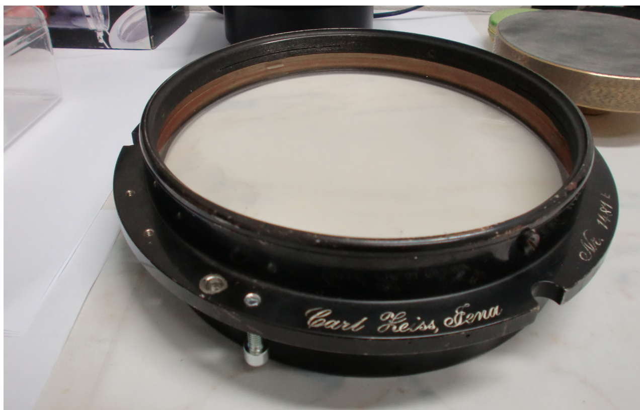
Obrázek 2. Objektiv 210/3450 Carl Zeiss Jena. Pohled z boku.
