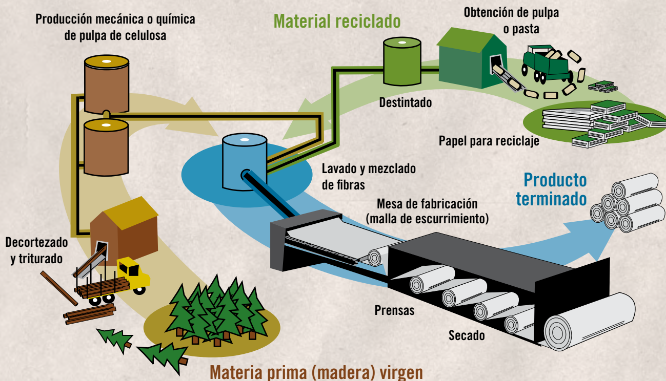
Gráfica 29. Diagrama esquemático de una planta típica de celulosa y papel.
