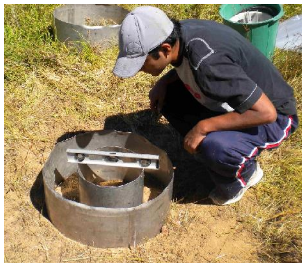
Foto 5. Nivelación de la anilla interior
